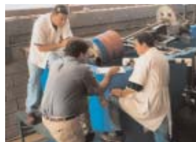
Máquina con rotor para medir propiedades de erosión
